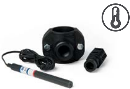
KIT SONDA NTC/1 Este KIT permite visionar la temperatura del agua de la piscina y en caso de trabajar en modo semiautomático permite gestionar la producción del equipo en función de la temperatura del agua . Válido para los equipos EVo y PRO. This KIT enables you to know the water pool temperature. Using Semi-automatic mode is possible to manage the production of the equipment according to the temperature of the water.
